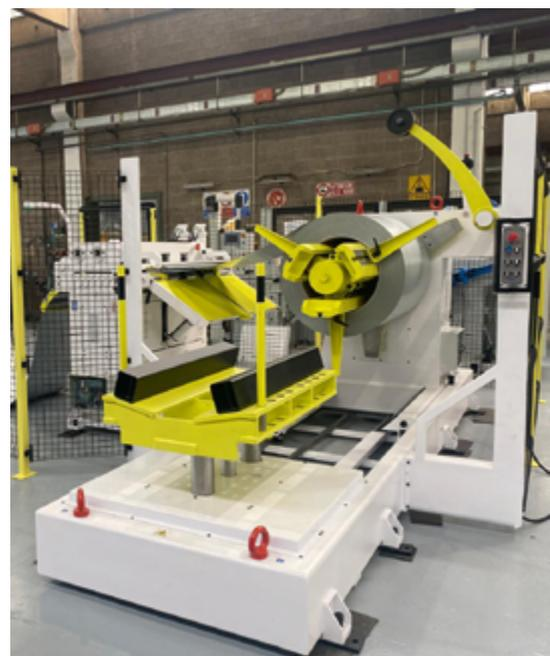
Lo **svolgitore motorizzato con sella di carico** sono costruiti su un unico basamento per ottenere un perfetto allineamento e per agevolare la fase di carico che avviene dal pulpito di comando senza che l'operatore entri in contatto con il materiale. Tutta la motorizzazione viene coordinata in fase automatica da un sensore ad ultrasuoni che rileva le variazioni di posizione del materiale nel loop.
