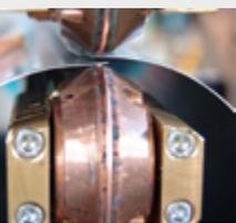
Una delle novità principali presentate da Cemsa sarà la **MRL F**, una saldatrice a rulli longitudinale progettata per la lavorazione di tubi, boiler e barili in lamiera zincata o acciaio inox. Grazie alla sua estrema precisione e versatilità, questa macchina è ideale per operazioni che richiedono una saldatura continua su superfici curve.
