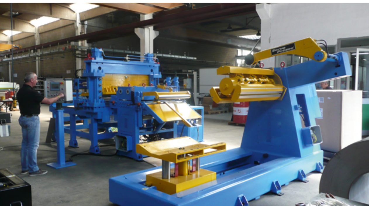
Linea Saldatrice testa-coda da coil 900 x 3 mm
